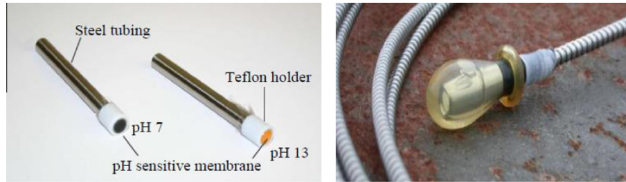
Fig. 18. Fibre optic pH sensor [85].
