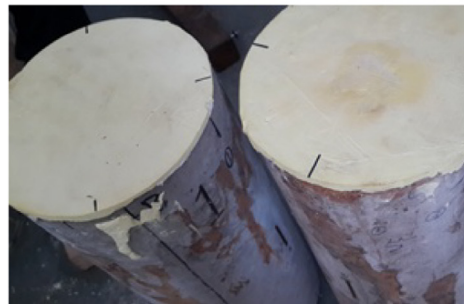
(d) End leveling of the steel ball concrete
