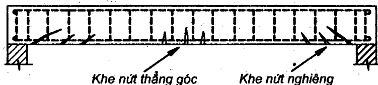
Hình 4.4. Các dạng khe nứt trong dầm đơn giản
